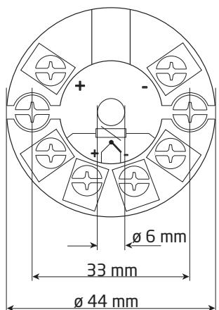
**Монтаж кабеля датчика**
